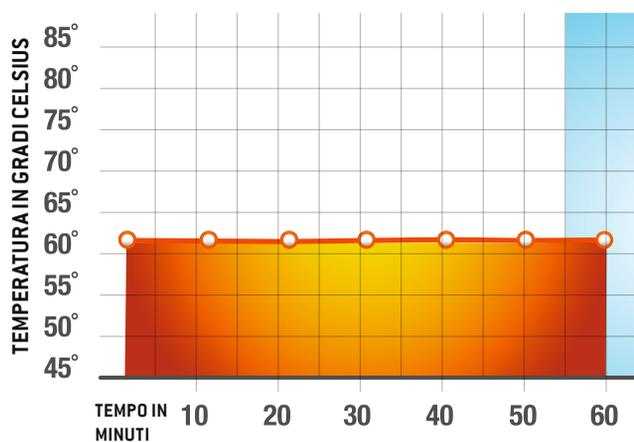
Per il mantenimento ottimo della temperatura, riscaldare il piatto del cibo a +90°-100°C prima di riempirlo con cibo caldo a circa 85°C.
